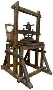
Modelo da máquina de impressão inventada por Gutenberg no século XV
